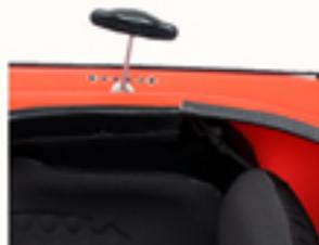
Durch Lösen der seitlichen Sitzschrauben kann die Sitzschale in einem Bereich von ca. 10 cm stufenlos verschoben werden.
